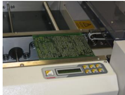
Platine in der Bestückungsmaschine
